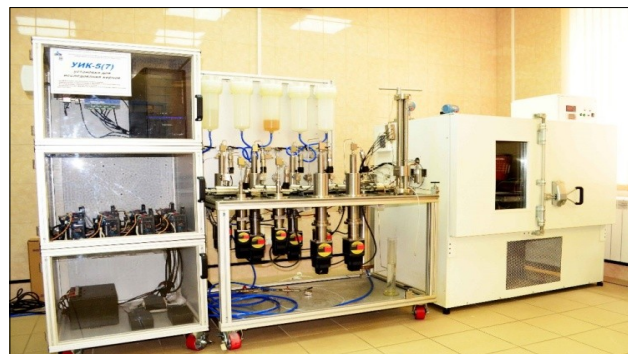
Фильтрационная установка УИК – 5(7) (ООО «Гло-Бел лаборатория»)
