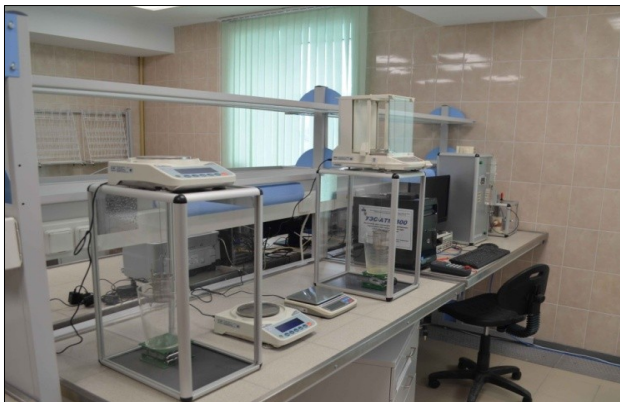
Установка для определения открытой пористости образцов керна методом жидкостенасыщения УОП-АТМ.200 (ЗАО «Аргоси»)
